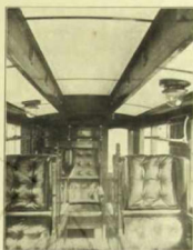
Figuur 35. Inrichting van het compartiment der 1e klasse van een vierassig rijtuig 1e en 2e klasse.
