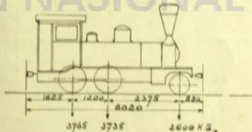
Figuur 30. 1-B tenderlocomotief. Schaal 1:100.
